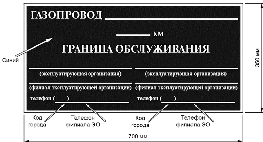
Рисунок Е.4 - Знак "Закрепления границ зон обслуживания"
