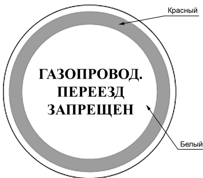
Рисунок Е.3 - Знак "Газопровод. Переезд запрещен"
